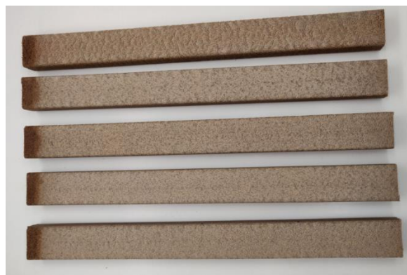
Figura 25. Muestras WPC tras 168 h de envejecimiento artificial.
