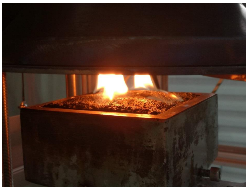
Figura 10. Detalle del cono calorimétrico sobre prototipos WPC+
