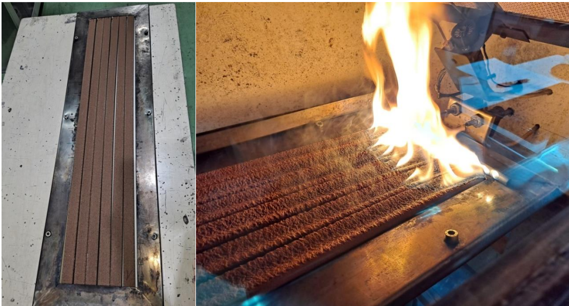
Figura 5. Panel radiante: prototipo fabricado en perfiles montado en marco y acción de las llamas piloto.
