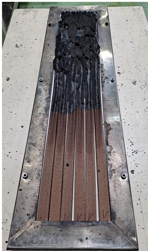
Figura 12. Aspecto prototipo fabricado tras ensayo panel radiante
