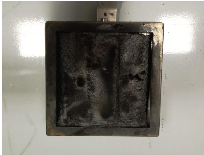
Figura 11. Prototipo WPC+_01 después del ensayo de reacción al fuego.
