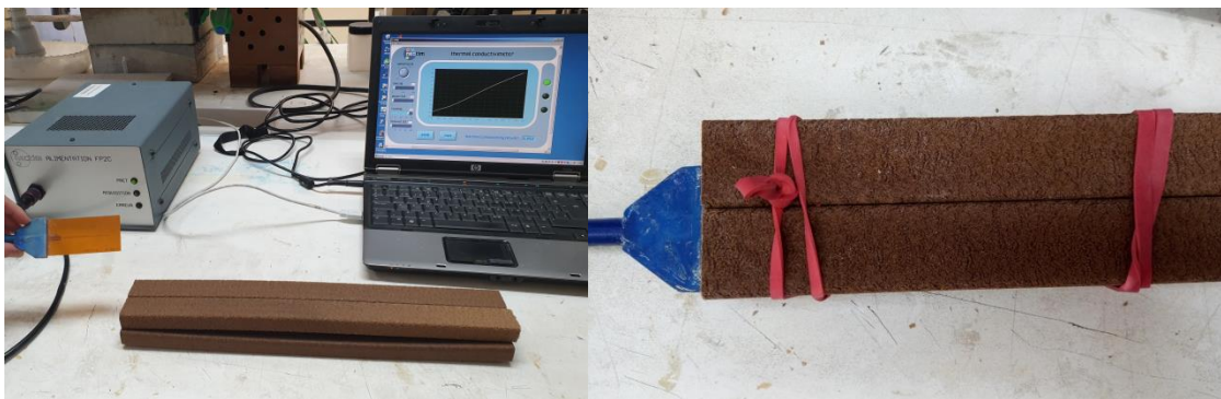
Figura 27. Muestras WPC y colocación del termopar para ensayar la conductividad térmica de las distintas probetas formuladas.
