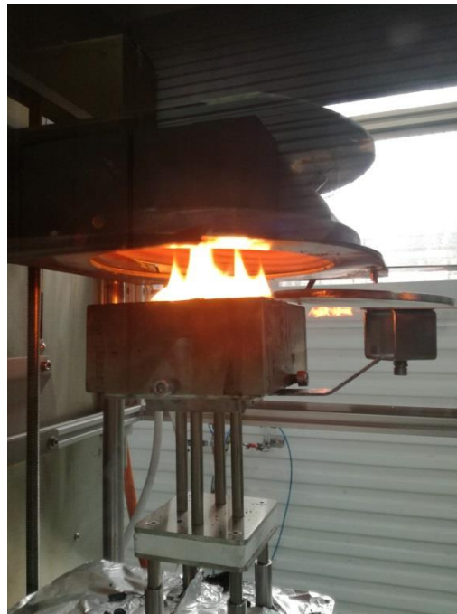
Figura 9. Ensayo del cono calorimétrico sobre prototipos WPC+
