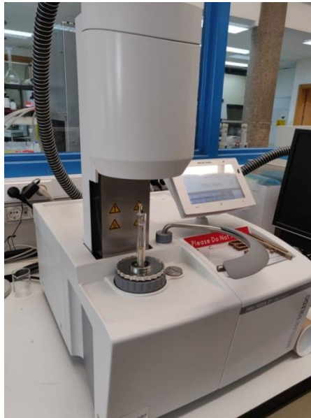
Figura 28. Equipo TMA utilizado para medir la dilatación térmica lineal de las 5 formulaciones.
