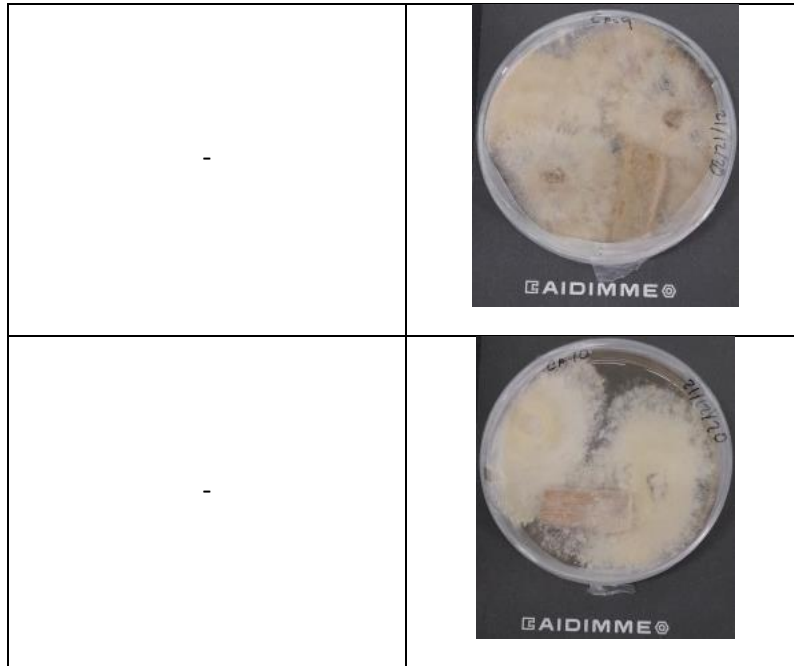
Figura 30 Imágenes de las probetas con el hongo de ensayo de virulencia de Coriolus versicolor y Coniophora puteana.
