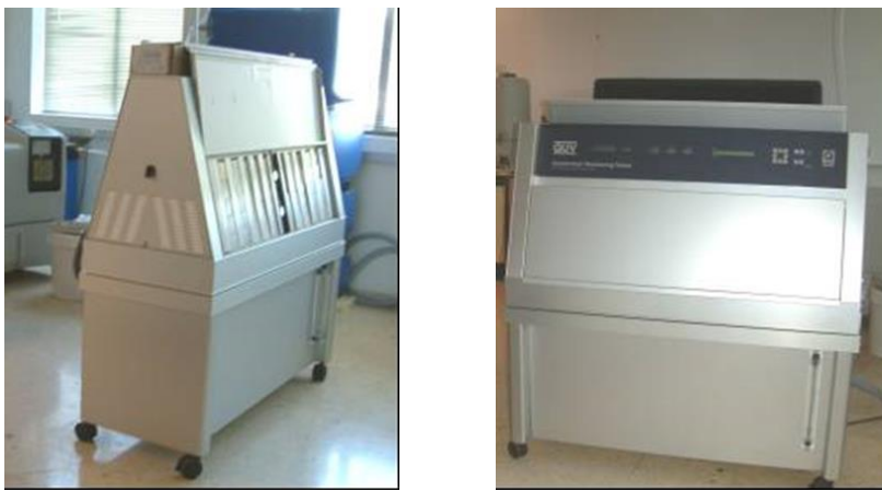
Figura 24. Equipamiento de envejecimiento artificial con lámparas UV, QUV.
