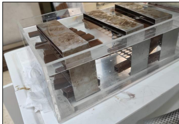
Figura 19. Ensayo de hinchazón y absorción de agua de probetas de perfil WPC+.
